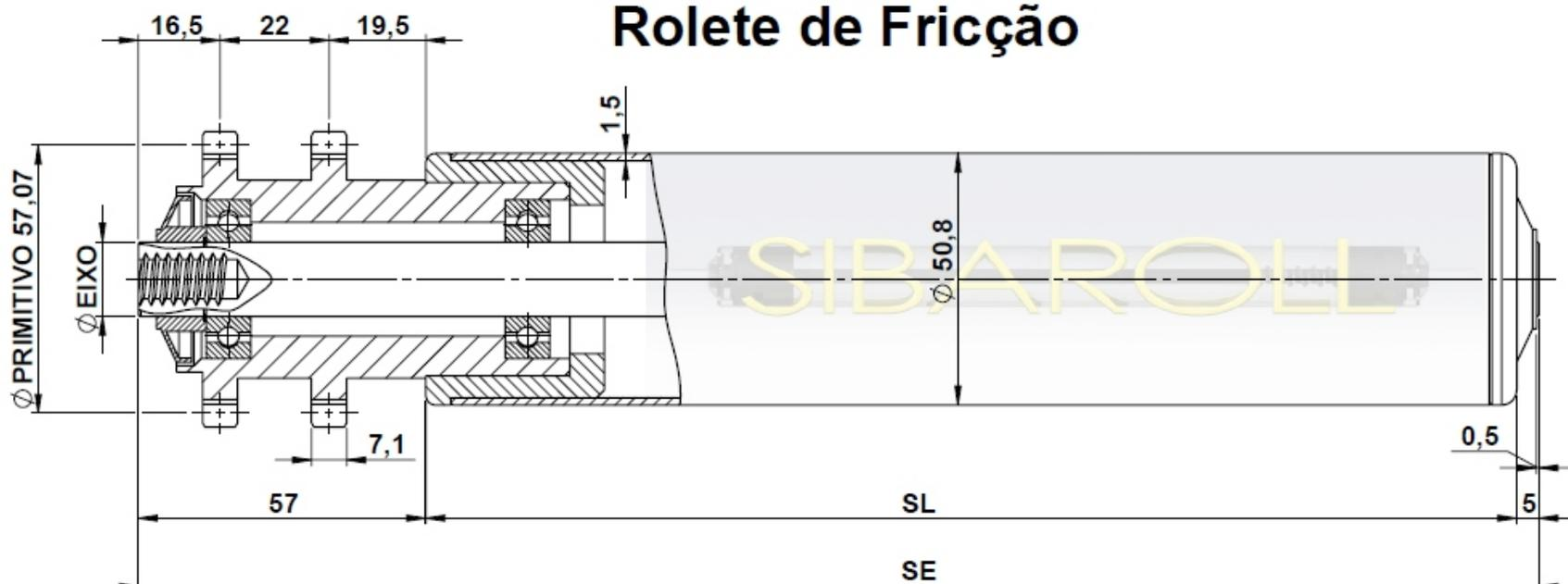
**Tubo:** Aço galvanizado, Inox, Alumínio e PVC.
