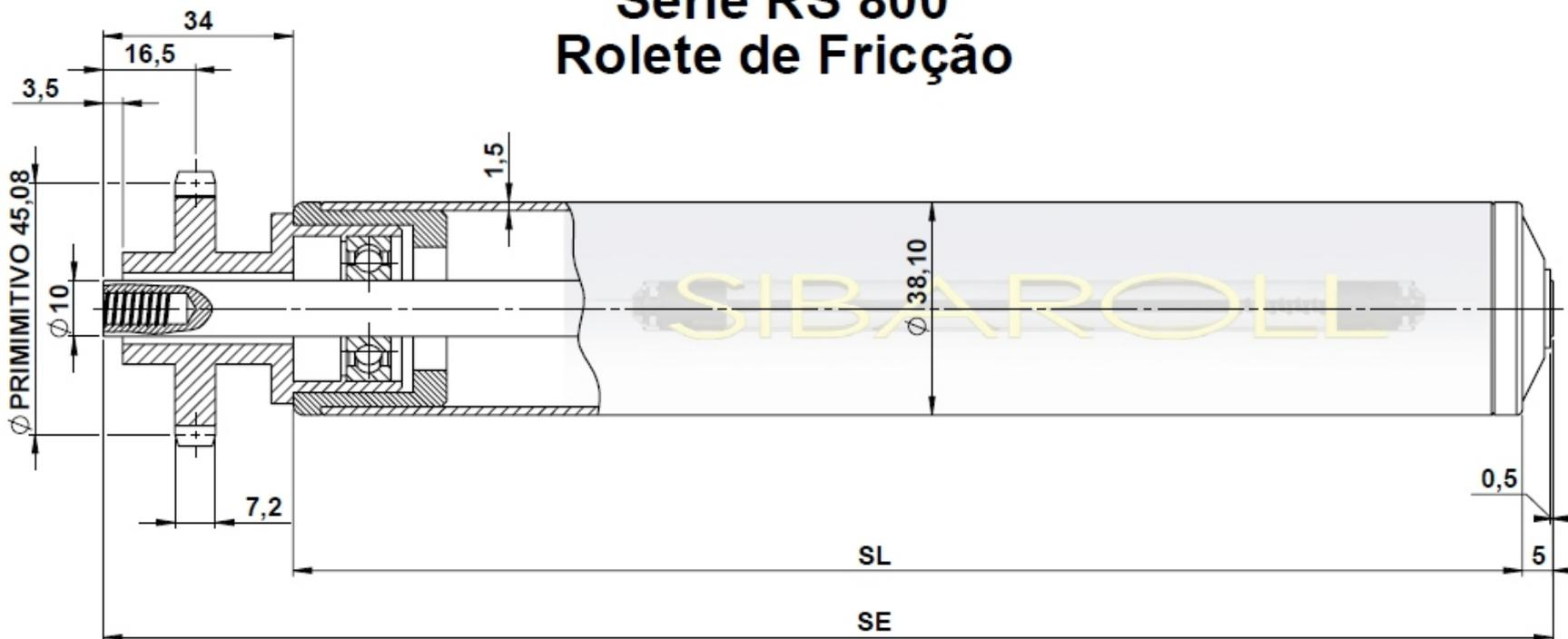
**Tubo:** Aço galvanizado, Inox, Alumínio e PVC.
